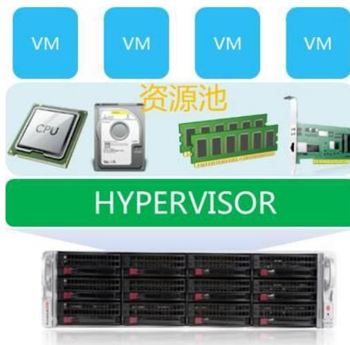
在桌面云环境下，所有资源都集中在数据中心，可实现资源的集中管控，弹性调度。资源的集中共享，提高了资源利用率。传统 PC 的 CPU 平均利用率为 5%~20%，桌面云环境下，云数据中心的 CPU 利用率可控制在 60%左右，整体资源利用率提高。桌面分享服务器硬件，配置资源可以按照用户需求动态调整。
